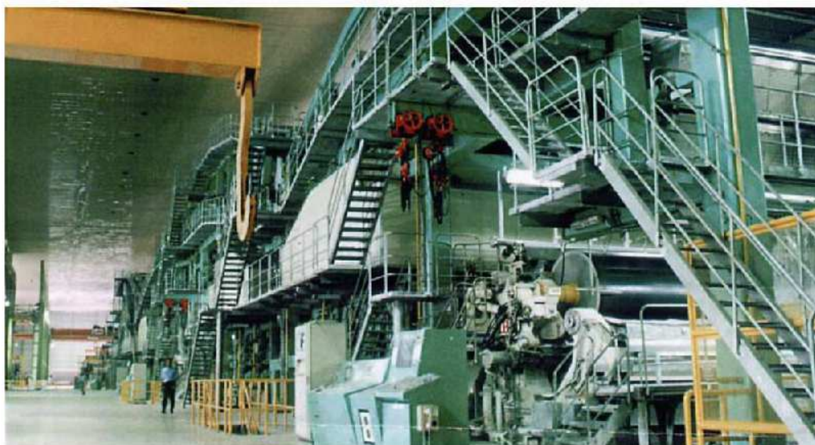
6900mmオフマシン塗工設備(ダブル塗工) 塗工速度 1800m/min(最高)
