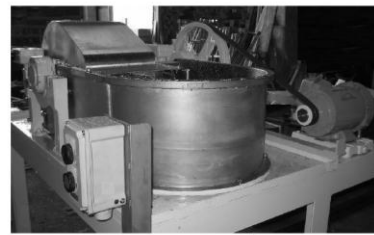
『紙はビーターで作られる』 『叩解機はビーター』 とも言われる最古の叩解機
